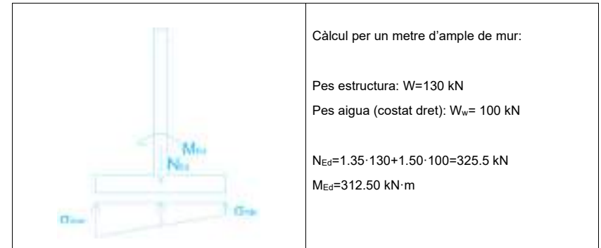
Figura 4. Esquema estructural del mur
