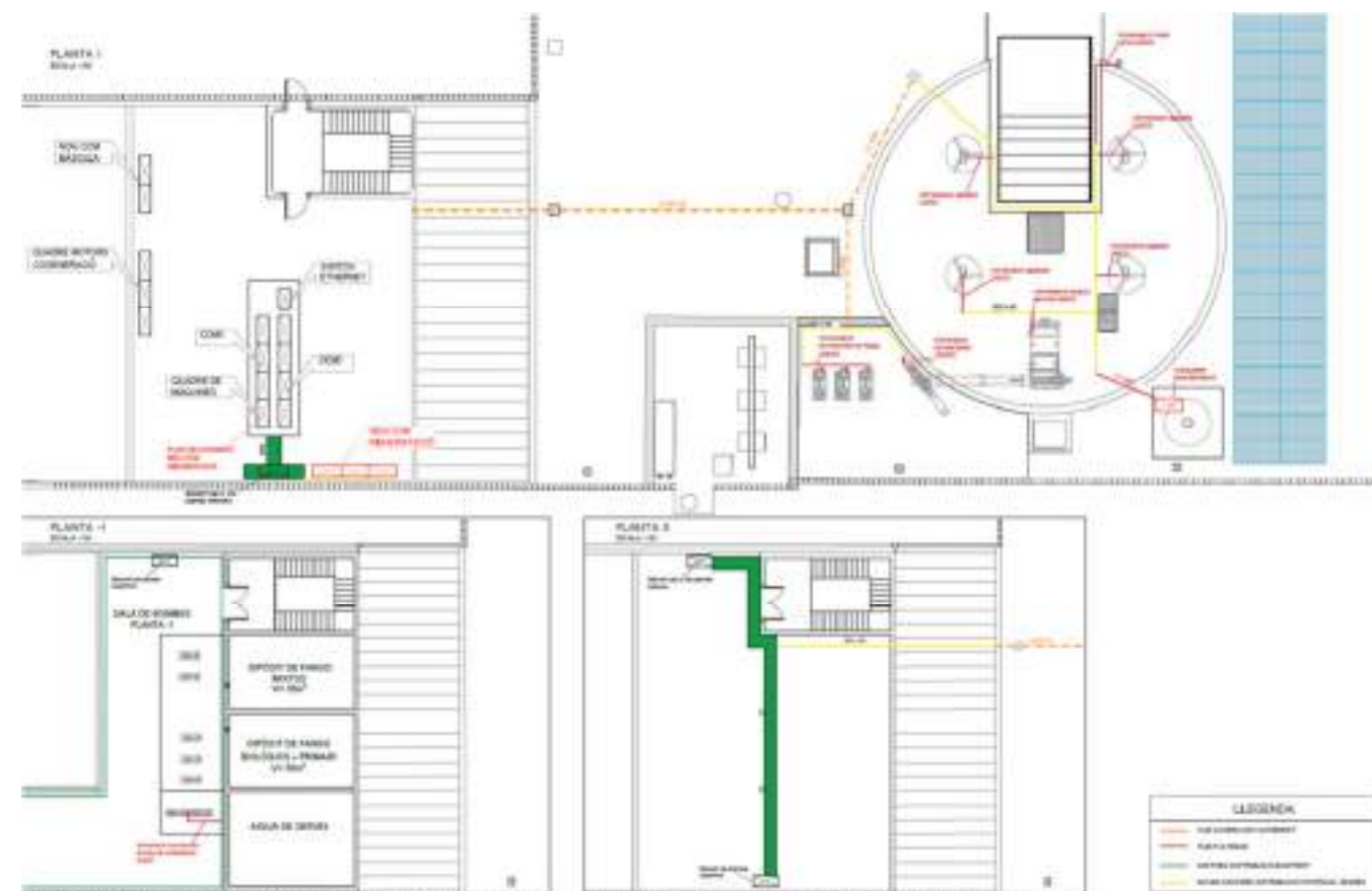
Figura 15: Planta general distribució elèctrica
